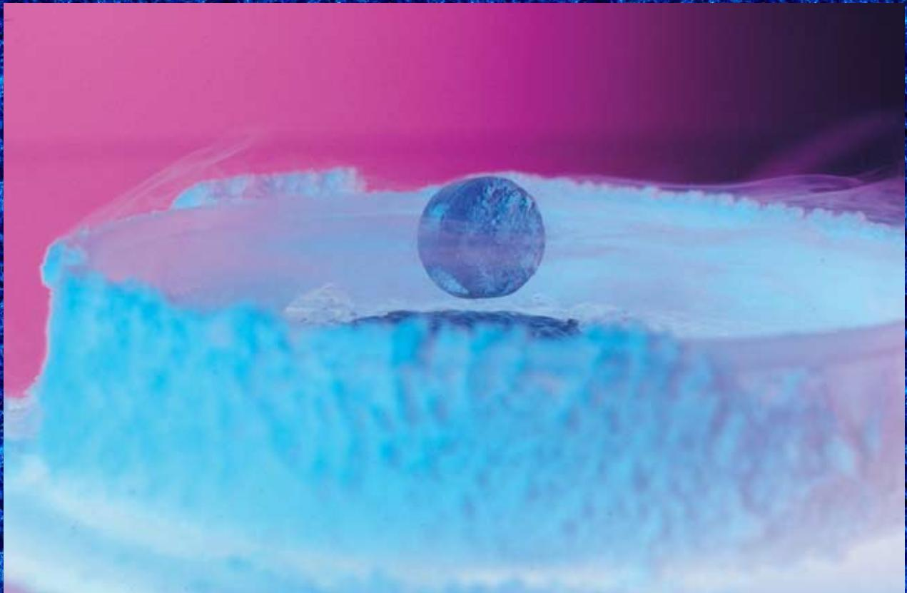
Levitación de un imán encima de un superconductor de alta temperatura crítica/
